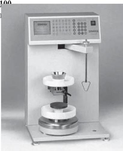
**Рис. 4.4.** Прибор для определения сыпучести и угла естественного откоса
