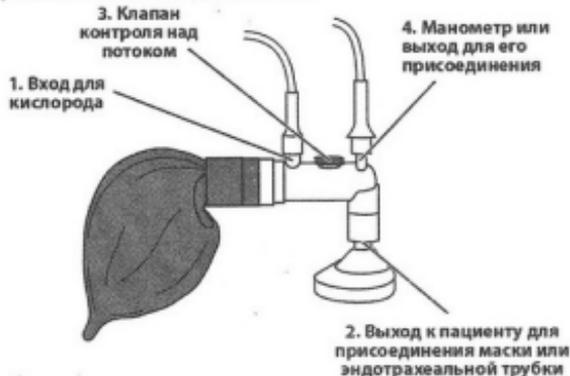
Рисунок 3Б.1. Функциональные части проточнонаполняющегося мешка
